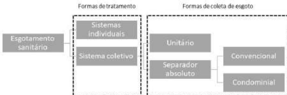
Figura II.2–Variantes dos sistemas de esgotamento sanitário
